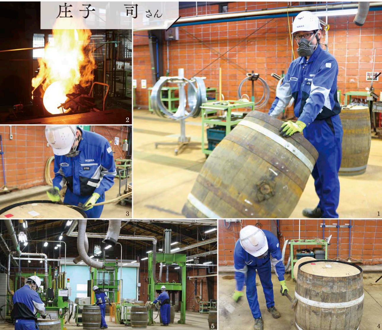
1.60~100kgにもなる樽を転がしながら運び、整備を重ねる。 2・3.樽の内面を焼く活性化の工程は高温になるため、夏は汗だくになった作業。 4・5.樽のたがを外し側面の木を入れ替える。多くの人の手に加えられ、古くなった樽も新しくウイスキーを入れる樽に蘇る。
